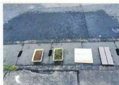
素材の上だけでなく、周りを 囲むように打ち水した。 (写真は打ち水をした直後)
